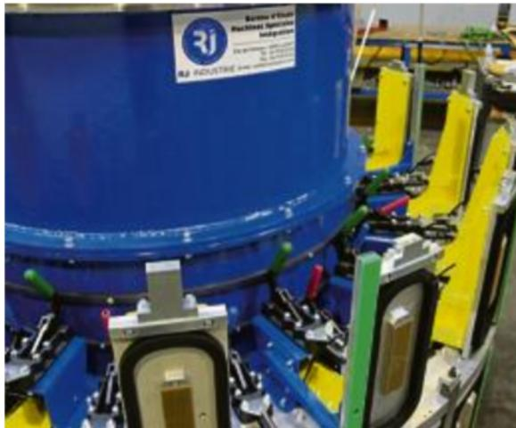
Prototype de machine permettant de souder par friction (FSW) les éléments de virole de lanceur pour Airbus Safran Launchers.
